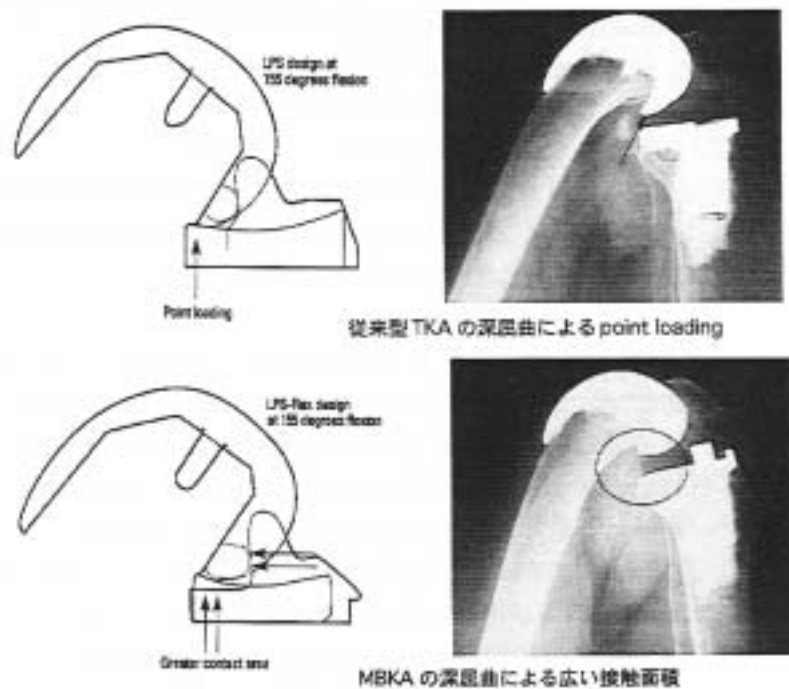
図9 155°屈曲時の接触面の増加
